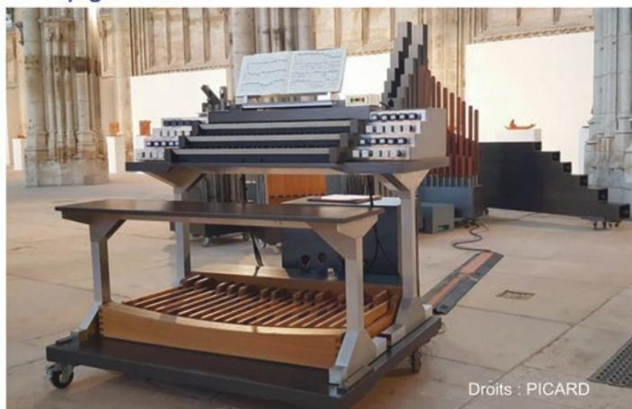
Neuf modules sur roulettes, une console et quatre ventilateurs forment un tout, qui fonctionne grâce à un système de traction électrique... Un orgue d'environ 350 tuyaux qui s'installe en une heure et rentre dans un utilitaire de 20 m<sup>3</sup>..
